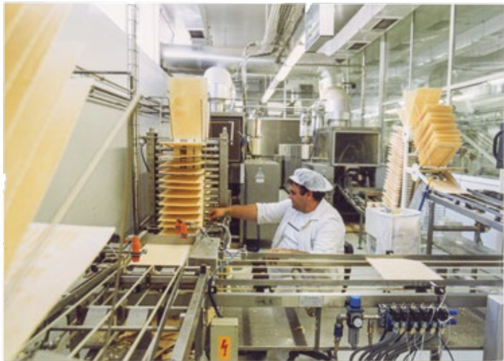
Изпичане на вафлени кори в помещението на днешните вафли с трите пекарки, 2000 г. Източник: фирмен архив
