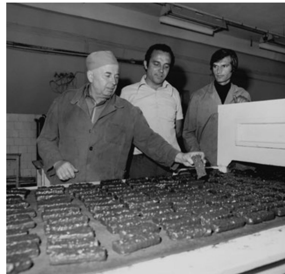
ТУНКВАНИ ВАФЛИ ИЗЛИЗАТ ОТ ХЛАДИЛНИЯ ТУНЕЛ Източник: ДА „Архиви“ Фонд 720, опис 5, а. е. 13.3 Захарна промишленост, албум 13-13, 79_2361_2
