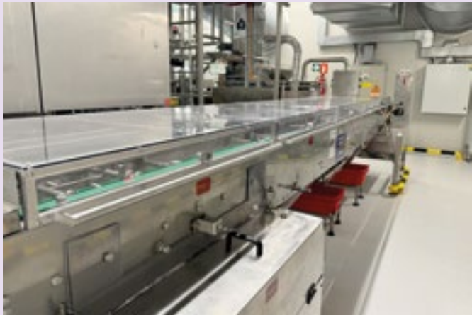
ПРЕДПАЗВАЩИТЕ КАПАЦИ НА ОБОРУДВАНЕТО НЕПРЕКЪСНАТО СЕ УСЪВЪРШЕНСТВАТ, КАТО СЕ ДОБАВЯТ ЗАКЛЮЧВАЩИ МЕХАНИЗМИ И ПРОЗРАЧНИ ЕЛЕМЕНТИ, С КОЕТО ДА СЕ ОСИГУРИ ВИДИМОСТ ВЪРХУ СЛУЧАЩОТО СЕ В МАШИНАТА ИЗТОЧНИК: ФИРМЕН АРХИВ
