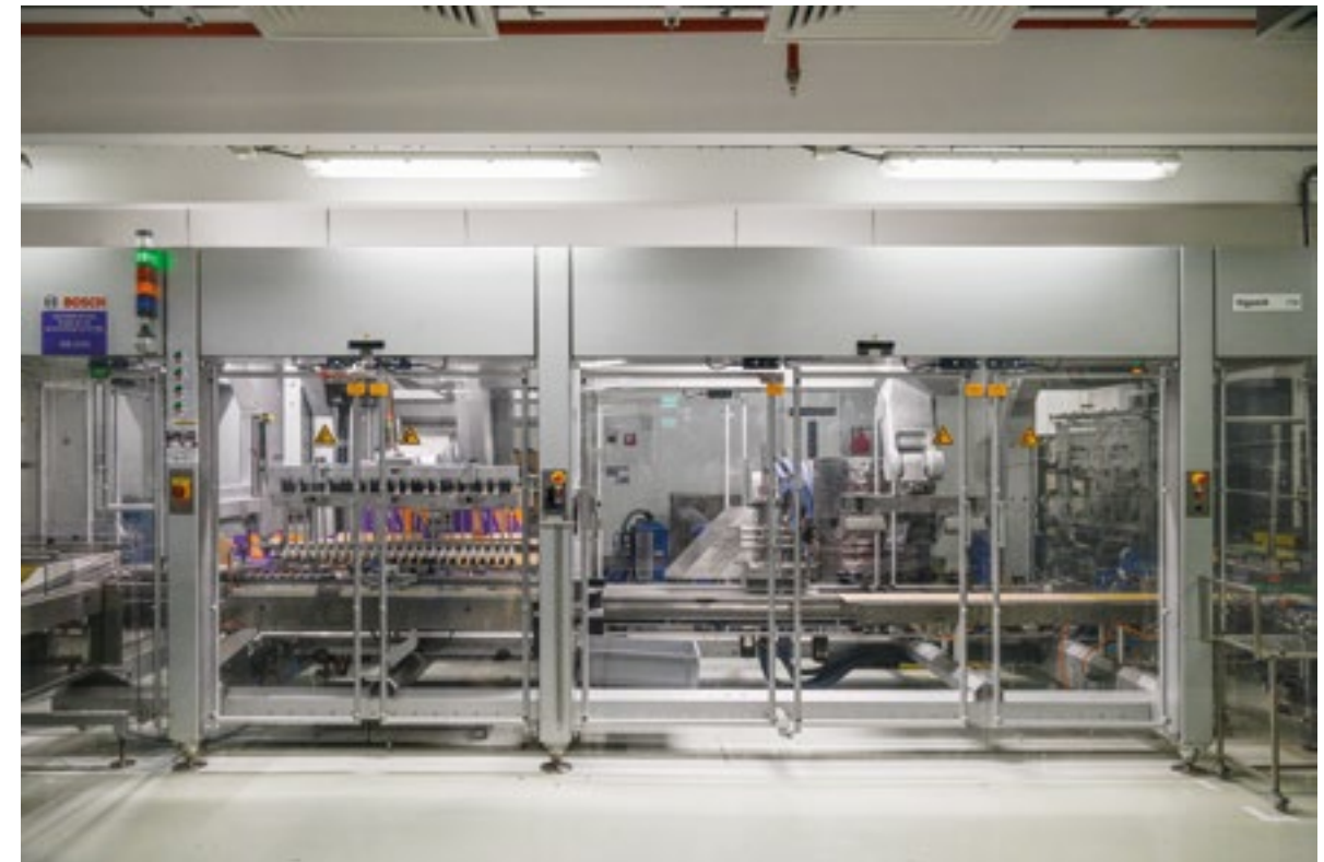
АВТОМАТИЧЕН МОДУЛ „TTM“ ЗА ПОДРЕЖДАНЕ НА ШОКОЛАДИ В КУТIIИ ИЗТОЧНИК: ФИРМЕН АРХИВ
