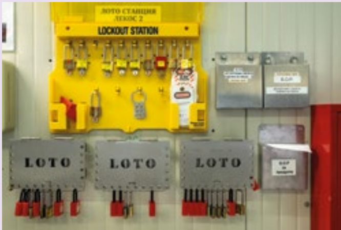
С ОБНОВЯВАНЕ НА „ЛОТО“ СТАНДАРТИТЕ ПРЕЗ 2016 Г. СА ОСИГУРЕНИ ИНДИВИДУАЛНИ КАТИНАРИ НА ВСИЧКИ СЛУЖИТЕЛИ, ЗА ДА ИМАТ ЛИЧЕН КОНТРОЛ ВЪРХУ ПРОЦЕСА ПО ОБЕЗОПАСЯВАНЕ НА МАШИНИТЕ ИЗТОЧНИК: ФИРМЕН АРХИВ
