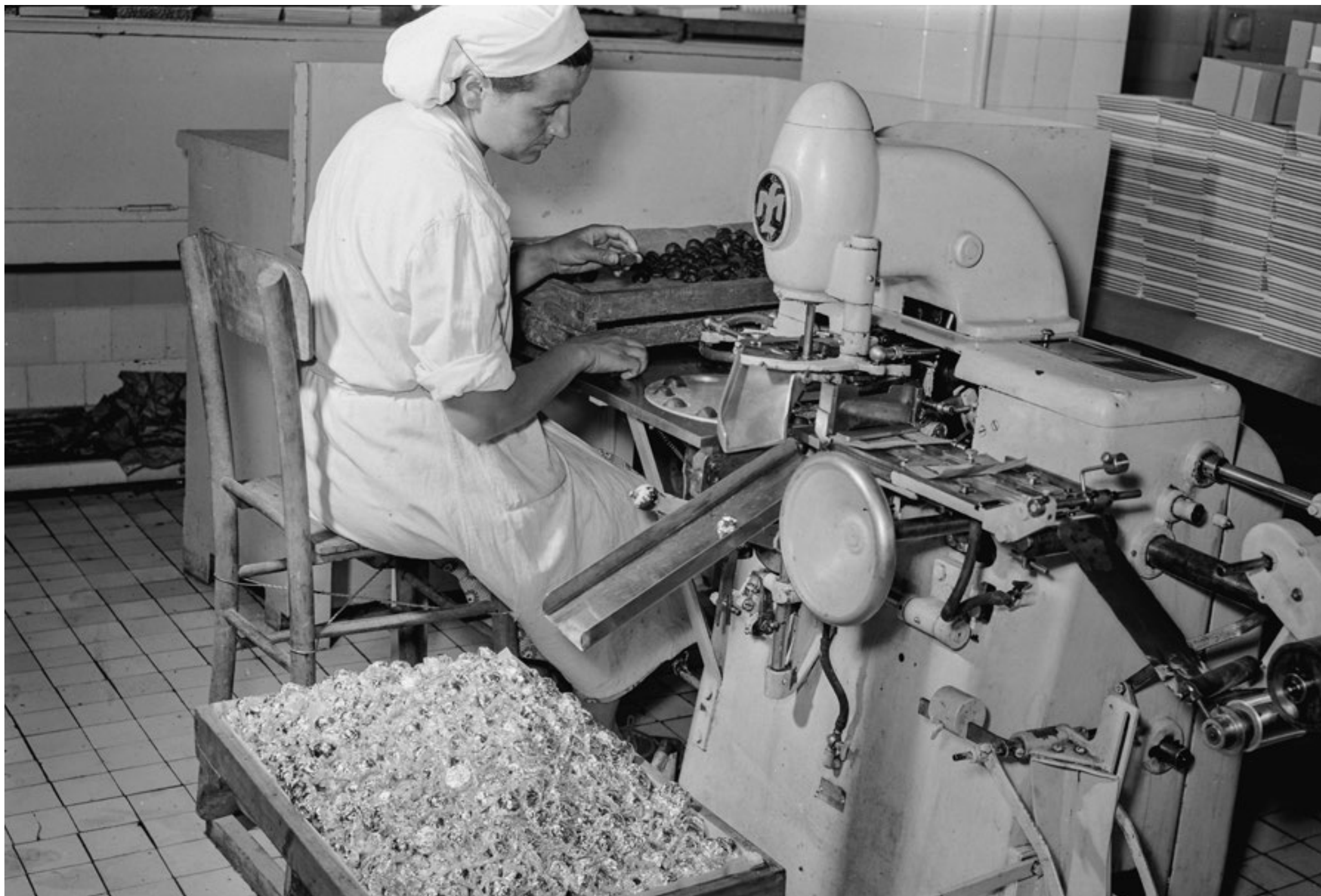
Опаковане на шоколадови бонбони – изделията се намират в дървена касетка вляво и ръчно се поставят от работника в машината, която ги увива във фолио, след което готовият продукт пада в касетката долу
