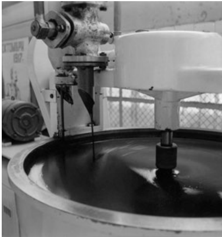
КОНУСНА КАМЕРА ЗА ТЕМПЕРИРАНЕ НА ШОКОЛАДОВА МАСА И ДОЗИРКА НА ЛИНИЯ „КАВЕМИЛ“ ПРЕЗ 60-ТЕ ГОДИНИ НА 20. ВЕК Източник: ДА „Архиви“ Фонд 720, опис 5, а.е.13.3 Захарна промишленост, АЛБУМ 13-Д, 67_2587_1
